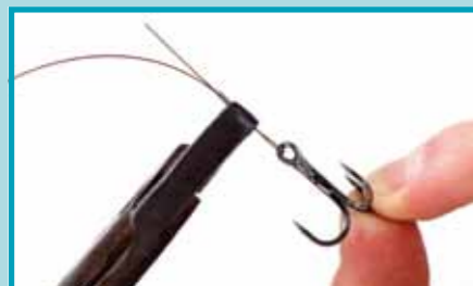
Stap 4: Knijp de sleeve nu stevig en in één keer plat met de sleevetang. Het platte oppervlak van de sleevetang zorgt ervoor dat de sleeve goed plat wordt 'geknedd'. De staaldraad klemt daardoor muurvast in dit 'buisje' en zal niet meer schuiven. Knopen zijn dus overbodig.
