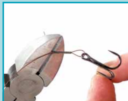
Stap 5: Knip nu het uitstekende en overtollige stuk staaldraad strak tegen de sleeve af. Gebruik een goede kniptang, zodat er geen scherpe rafels ontstaan.
