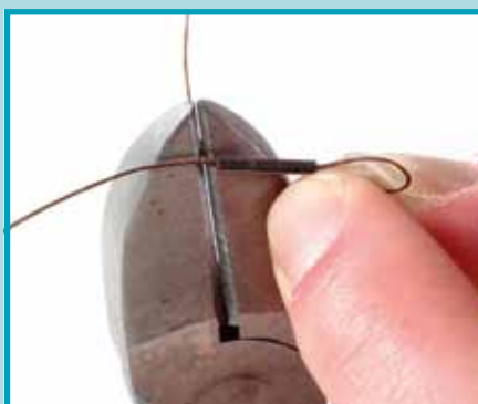
Stap 5: Knip het uiteinde dicht tegen de sleeve aan af.
