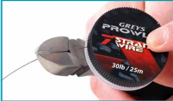
Stap 1: Knip een stuk van zo'n 60 cm staaldraad of titanium af. Voor langere onderlijnten neem je wat extra centimeters.
