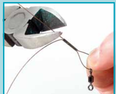
Stap 7: Sleeve platknijpen en uitsteeksel weer afknippen.
