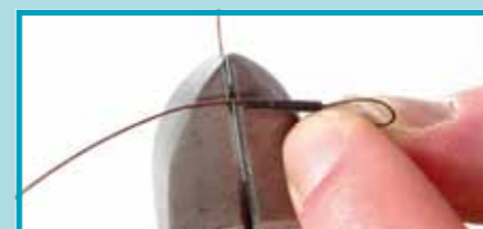
Stap 15: Knip het staaldraad dat uitsteekt strak tegen de sleeve af.
