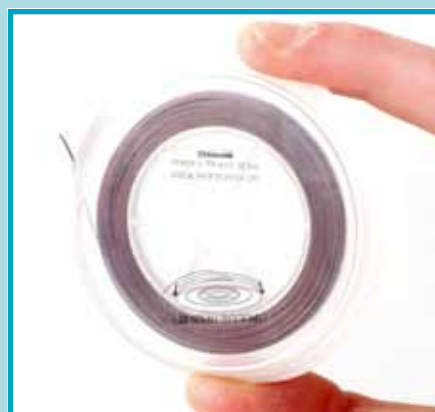
Stap 1: Knip van een klosje staaldraad een stuk van zo'n 80 - 100 cm af.
