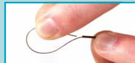
Stap 12: Nu maken we een lus door een sleeve over het uiteinde van de staaldraad te schuiven en dit weer terug te halen.
