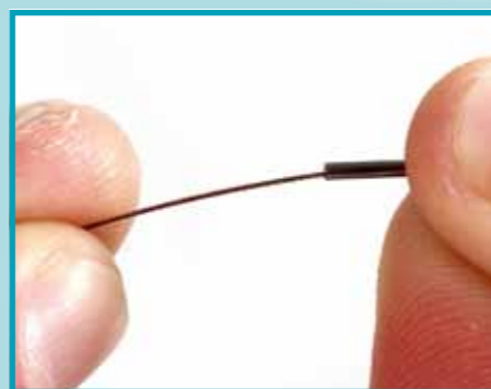
Stap 2: Schuif eerst een sleeve op de staaldraad. Let op dat je een maat sleeve neemt die correspondeert met de dikte van je onderlijnmateriaal.
