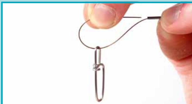
Stap 3: Steek het uiteinde van de staaldraad nu weer terug door de sleeve heen.
